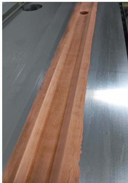
รูปที่ 2 การชุบทองแดงด้วยไฟฟ้าลงบนพื้นผิวด้านในของท่อสุญญากาศ PVCB2 Upper Plate วัสดุเหล็กกล้าไร้สนิม ที่มีขนาดความยาว 3.7 เมตร
