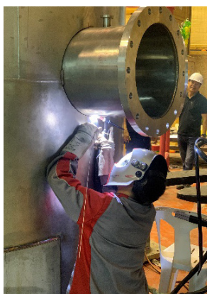
รูปที่ 10 เตาเชื่อมเส้นประสานแนวตั้งขนาดใหญ่ (Brazing)
