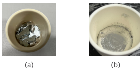
รูปที่ 2 สาร InGaSn ในอัตราส่วน 65:25:10 (a) ก่อน (b) หลัง การให้ความร้อน
