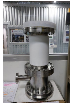
รูปที่ 8 ผลิต ประกอบและทดสอบ Electron Gun
