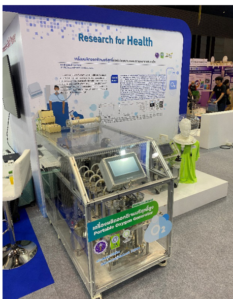
รูปที่ 6 ผลิต ประกอบและทดสอบชุดผลิตออกซิเจนสำหรับโรงพยาบาลขนาดเล็ก
