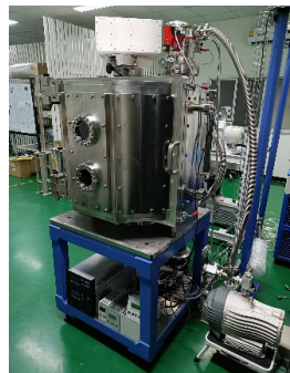
รูปที่ 9 ผลิต ประกอบและทดสอบ DLC coating Machine Prototype
