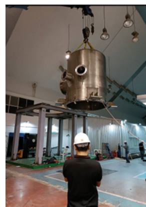
รูปที่ 10 เตาเชื่อมเส้นประสานแนวตั้งขนาดใหญ่ (Brazing)
