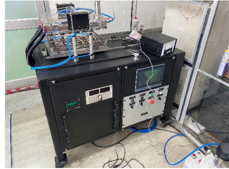
รูปที่ 7 ผลิต ประกอบและทดสอบต้นแบบเครื่องผลิตกราฟีน
