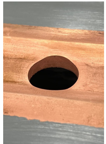
รูปที่ 2 การชุบทองแดงด้วยไฟฟ้าลงบนพื้นผิวด้านในของท่อสุญญากาศ PVCB2 Upper Plate วัสดุเหล็กกล้าไร้สนิม ที่มีขนาดความยาว 3.7 เมตร
