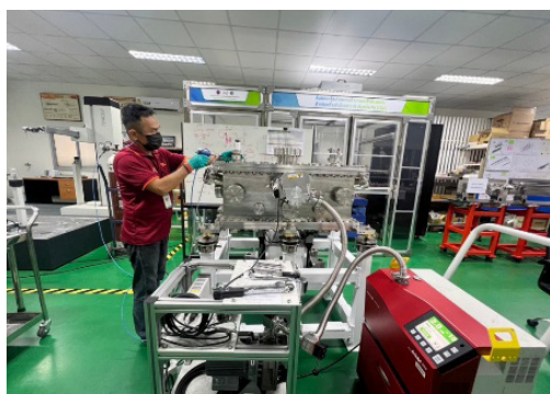
รูปที่ 4 การประกอบทดสอบห้องสุญญากาศสำหรับระบบกระจก CM
