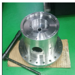
รูปที่ 11 ออกแบบ ชั้นรูป ต้นแบบ Scanning Electron Microscope (SEM)
