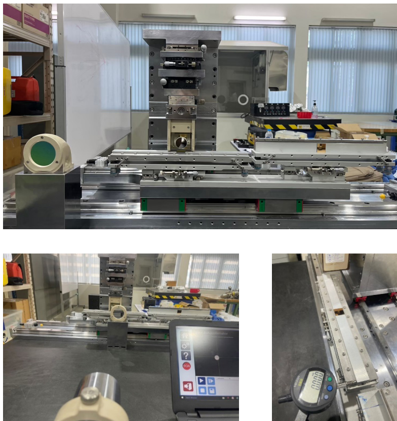
รูปที่ 9 ต้นแบบ test station สำหรับปรับตำแหน่งกระจกรังสีเอกซ์ในระบบกระจก KB (บน) โดยออกแบบให้ใช้ autocollimator (ล่างซ้าย) และ dial gauge (ล่างขวา) ในการตรวจสอบค่าความคลาดเคลื่อน
