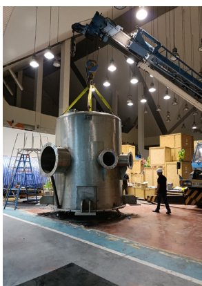
รูปที่ 10 เตาเชื่อมเส้นประสานแนวตั้งขนาดใหญ่ (Brazing)
